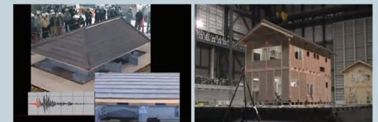
「寄棟」形状の屋根での実験の様子。瓦の脱落、ズレ、浮き上がり等は一切確認されませんでした。(2004年10月実施)
